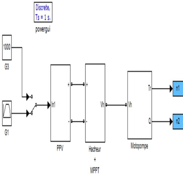
Figure 4. Bloc Simulink relatif au système de pompage
