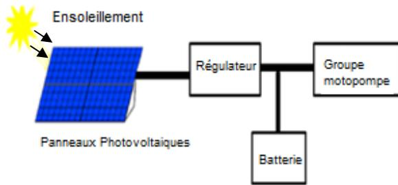
Figure 1. Structure d'un système de pompage Photovoltaïque.
