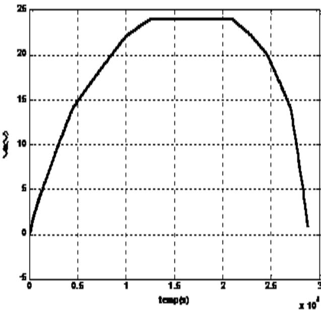
Figure 9. Allure de la tension d'alimentation du moteur
