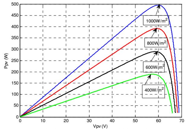
Figure 3. Caractéristiques du GPV en fonction de l'ensoleillement.
