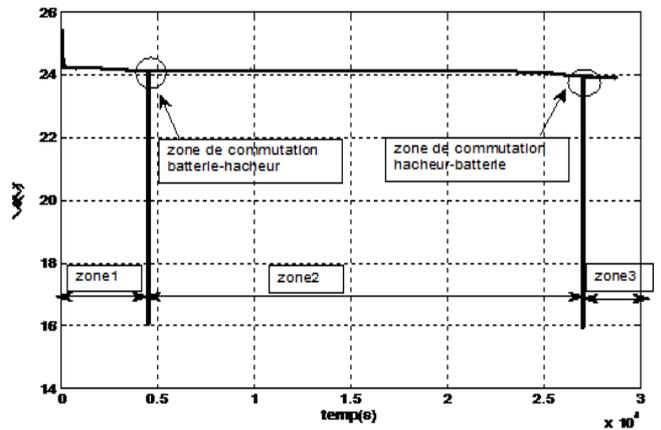
Figure 14. Allures de la tension du moteur.
