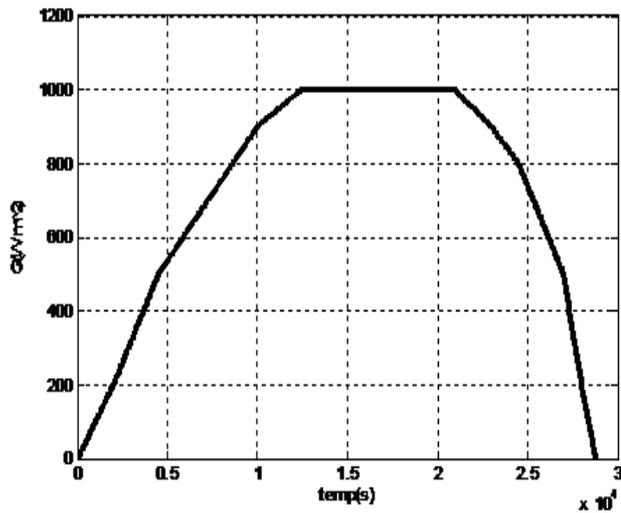
Figure 12. Allure théorique d'ensoleillement des panneaux photovoltaïques.
