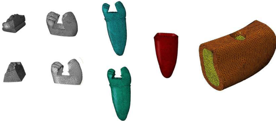
Figure. 5 – Maillage utilisant des éléments linéaires tétraédriques.
