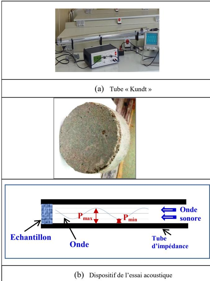
Figure 2 Mesure des propriétés acoustiques
