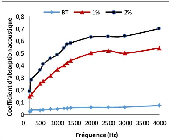
Figure 5 Variation du Coefficient d'absorption acoustique en fonction de la fréquence pour  $L_f=40\text{mm}$  [26]
