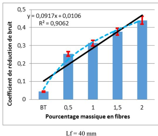
Figure 6 Coefficient de réduction du bruit en fonction de la teneur et la longueur des fibres de palmiers dattiers [26].
