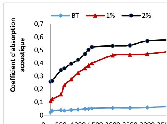
Figure 4 Variation du Coefficient d'absorption acoustique en fonction de la fréquence pour  $L_f=10\text{mm}$  [26]
