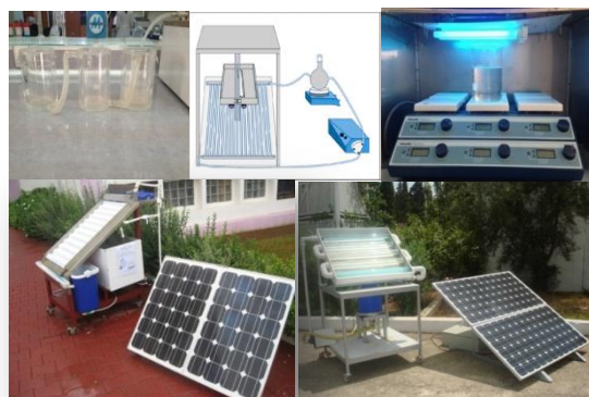
Fig.1. Photoreacteurs développés à l'UDES EPST CDER.
