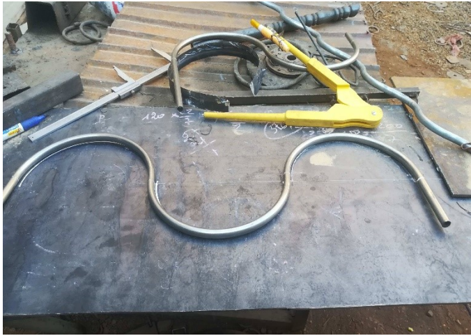
Fig.5 Ajustement du Tube sur le Gabarit de Cintrage Rayon R=120 mm
