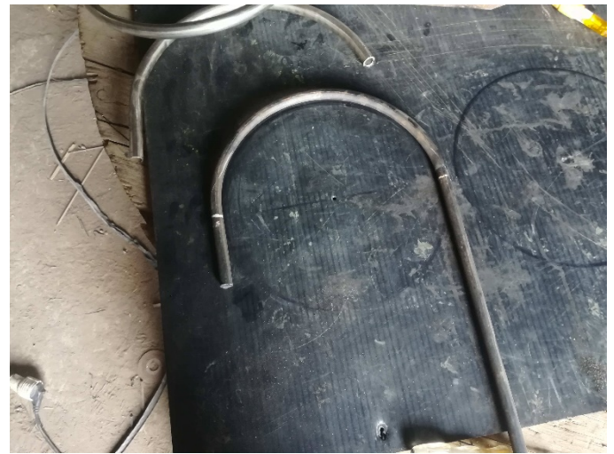
Fig.4 Gabarit de cintrage rayon R=80 mm
