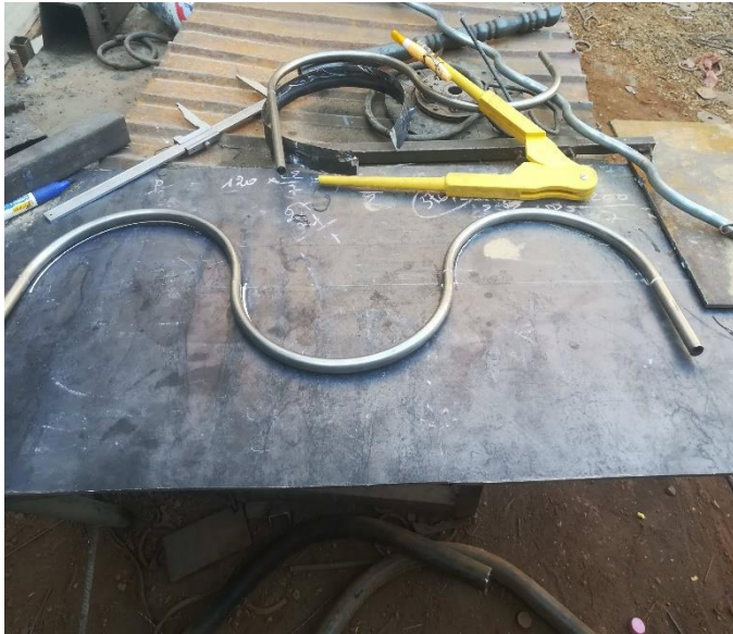
Fig.5 Ajustement du tube sur le Gabarit de cintrage rayon R=120 mm
