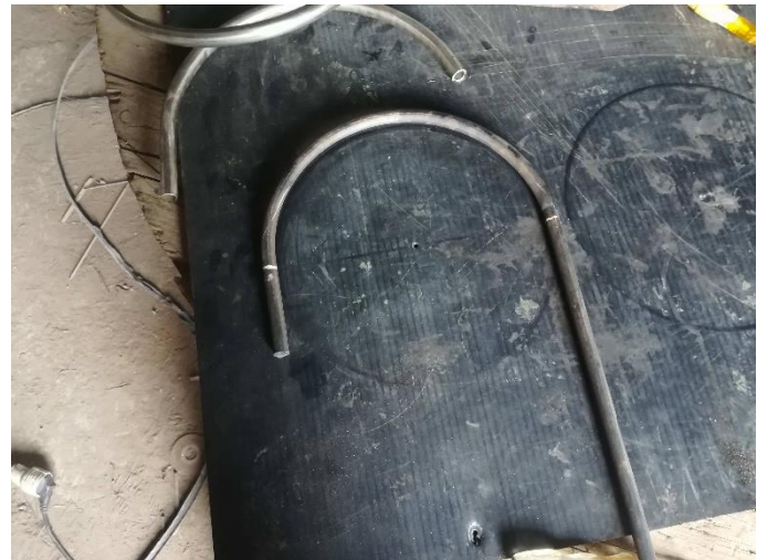
Fig.4 Gabarit de cintrage rayon R=80 mm
