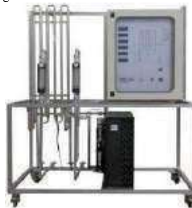
Fig.1 : Dispositif expérimental de l'échangeur thermique eau/eau de type concentrique
