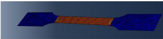
Fig 8.eprouvette de traction après l'essai de traction unidirectionnel.
