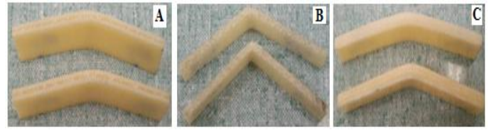
Fig.6 Eprouvettes rompues en flexion des lots A, B et C.
