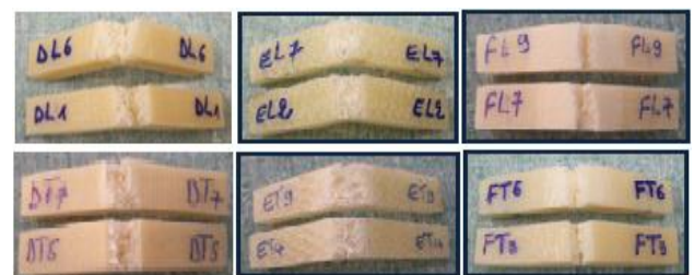
Fig.17 Eprouvettes rompues par choc des lots D, E et F
