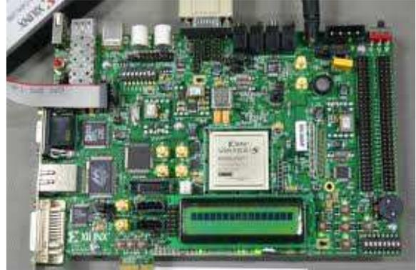
Fig. 3 Xilinx Virtex-5 FPGA Evaluation Platform
