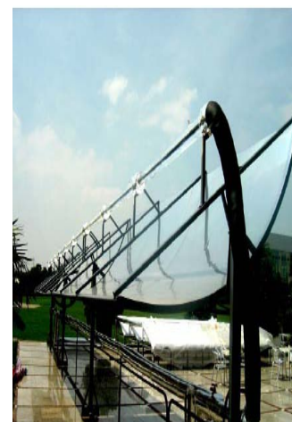
Fig. 2 Capteur cylindro-parabolique installé en Espagne, Source : http://www.spb.de
