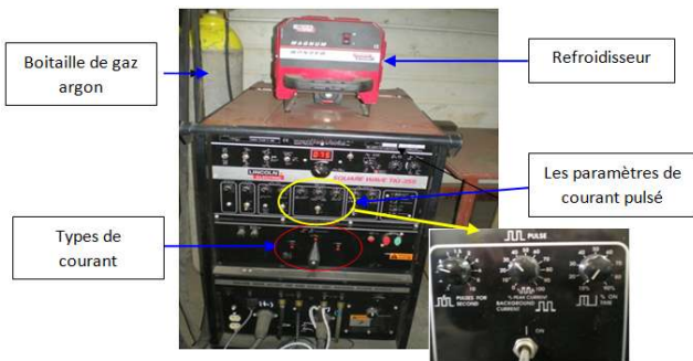
Fig 2 : générateur de courant et bouteille de gaz argon.
