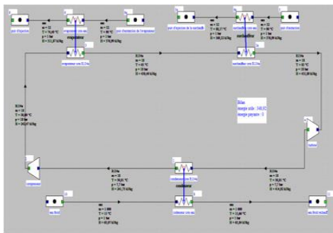
FIG 8. Schéma d'une centrale géothermale avec son bilan global (cycle simple avec surchauffeur)
